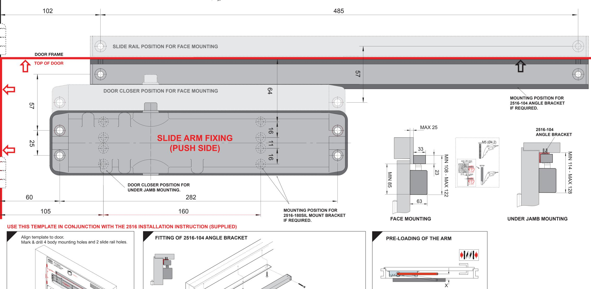
SLIDE ARM FIXING (LEFT HAND DOOR PUSH SIDE)
