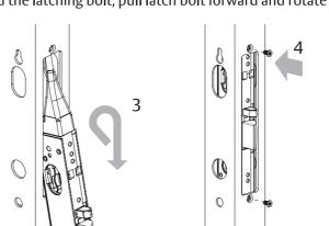
FACE PLATE AND SPINDLE INSTALLATION
